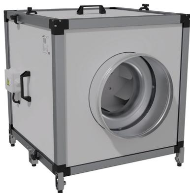
Вентиляторы VCB-LT – серия канальных вентиляторов для круглых каналов со свободным рабочим колесом. Лопатки рабочего колеса загнуты назад. Корпус вентиляторов изготовлен из каркасно-панельного алюминиевого профиля с утепленными ППУ панелями.
